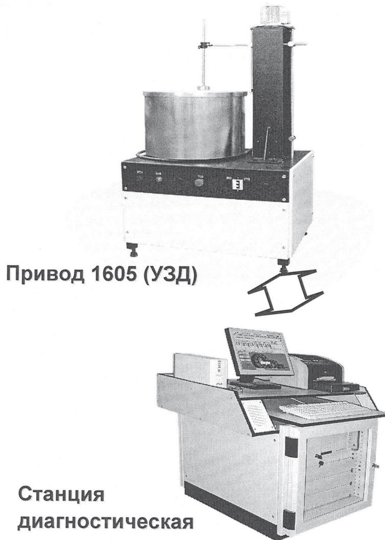
**Рис. 4. Система стендовая ультразвукового контроля подшипников скольжения КОМПАКС®-УЗД**
