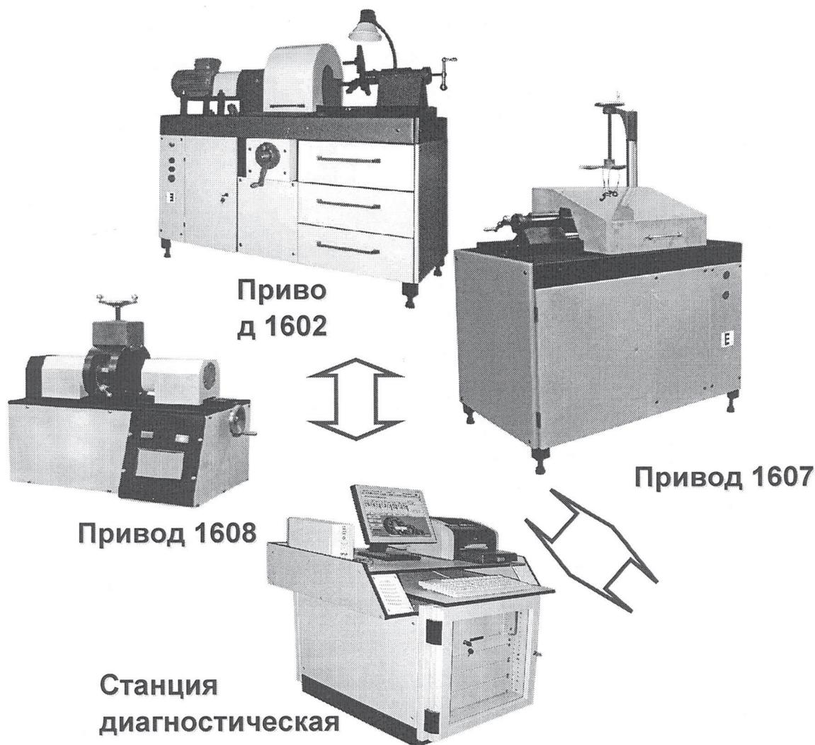
**Рис. 3. Система стендовая вибродиагностики подшипников качения
