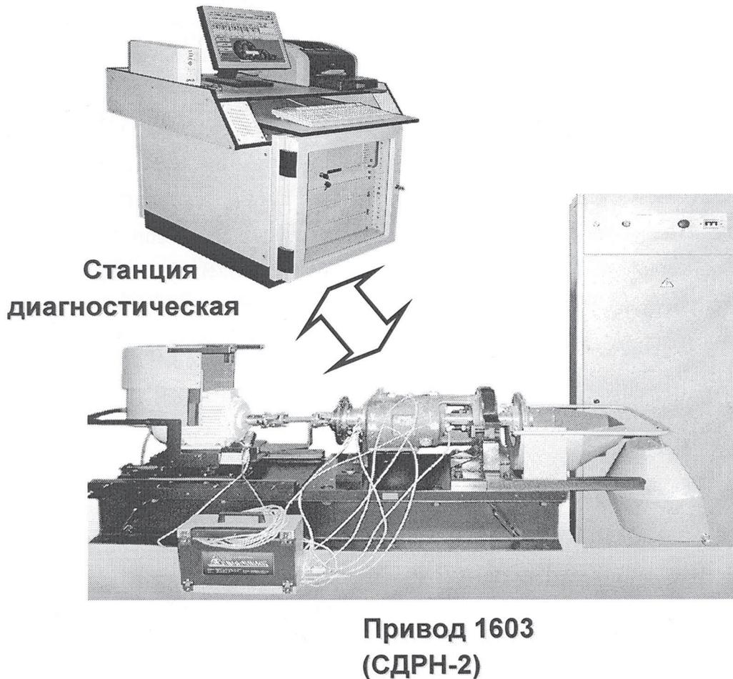
**Рис. 5. Система стендовая диагностики и динамической балансировки роторов консольных насосов в собственных подшипниках КОМПАКС®-РПМ**
