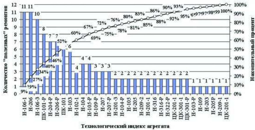
Распределение ремонтов оборудования технологической установки
