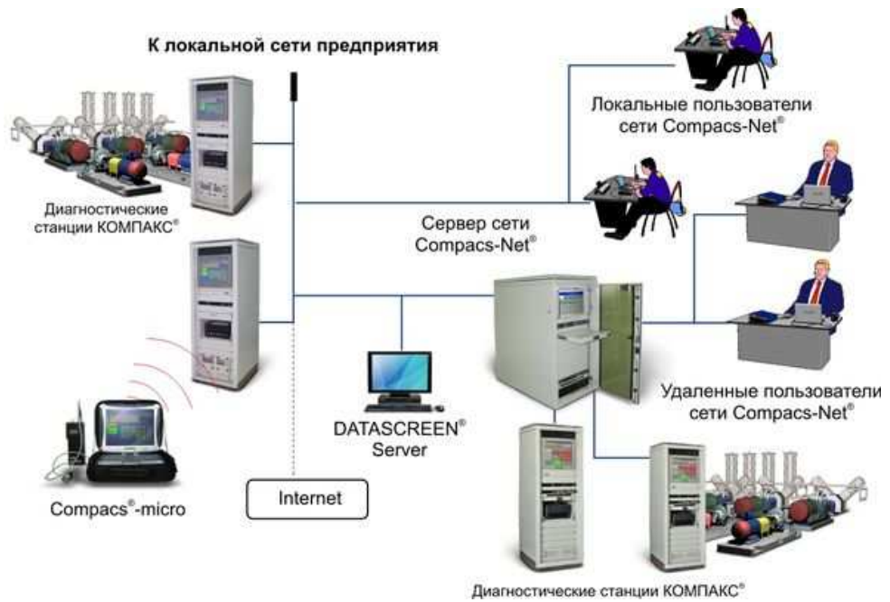
Схема диагностической сети предприятия Compacs-Net®
