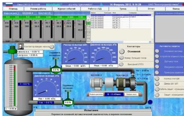
Экран станции управления в режиме «ПЕРИОДИЧЕСКИЕ ИСПЫТАНИЯ»
