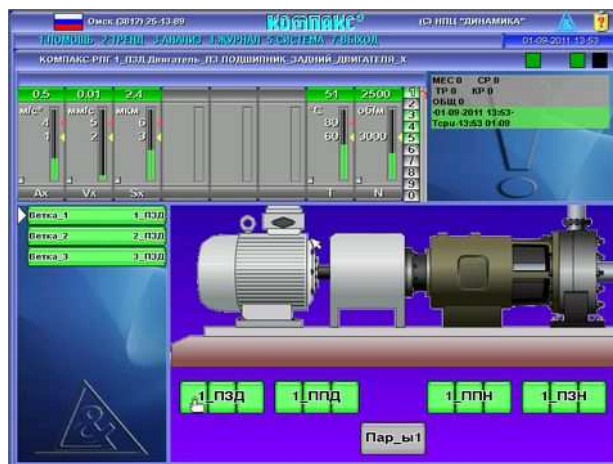
Экран станции диагностики в режиме «МОНИТОР»
