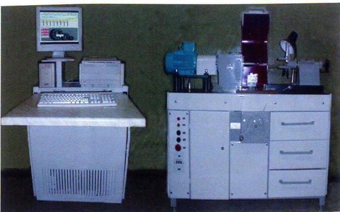
Рис. 3. Система вибродиагностики подшипников качения КОМПАКС®-РПП
