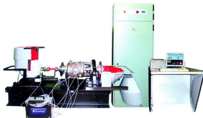
Рис. 1. Система диагностики и динамической балансировки роторов консольных насосов в собственных подшипниках КОМПАКС®-РПМ
