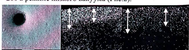
Рис. 2. а – SEM-изображение дефекта в лакокрасочном покрытии; б, в – Распределение элементов лакокрасочной композиции в структуре подложки
